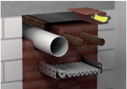
Прокладка труб из горючих материалов без дополнительных мер по защите.
