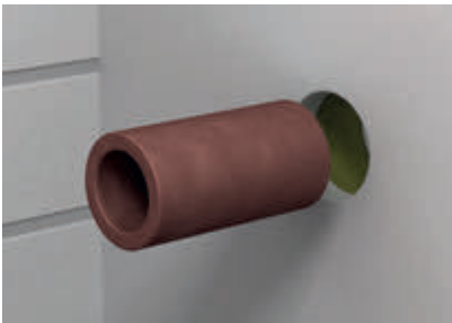
Установить огнестойкую оболочку в легкую разделительную перегородку.
